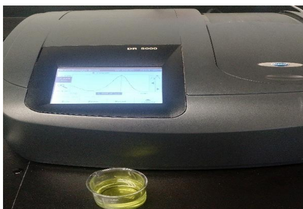
Fig. 26. Monitoreo de la reducción química del 4-nitrofenol.
