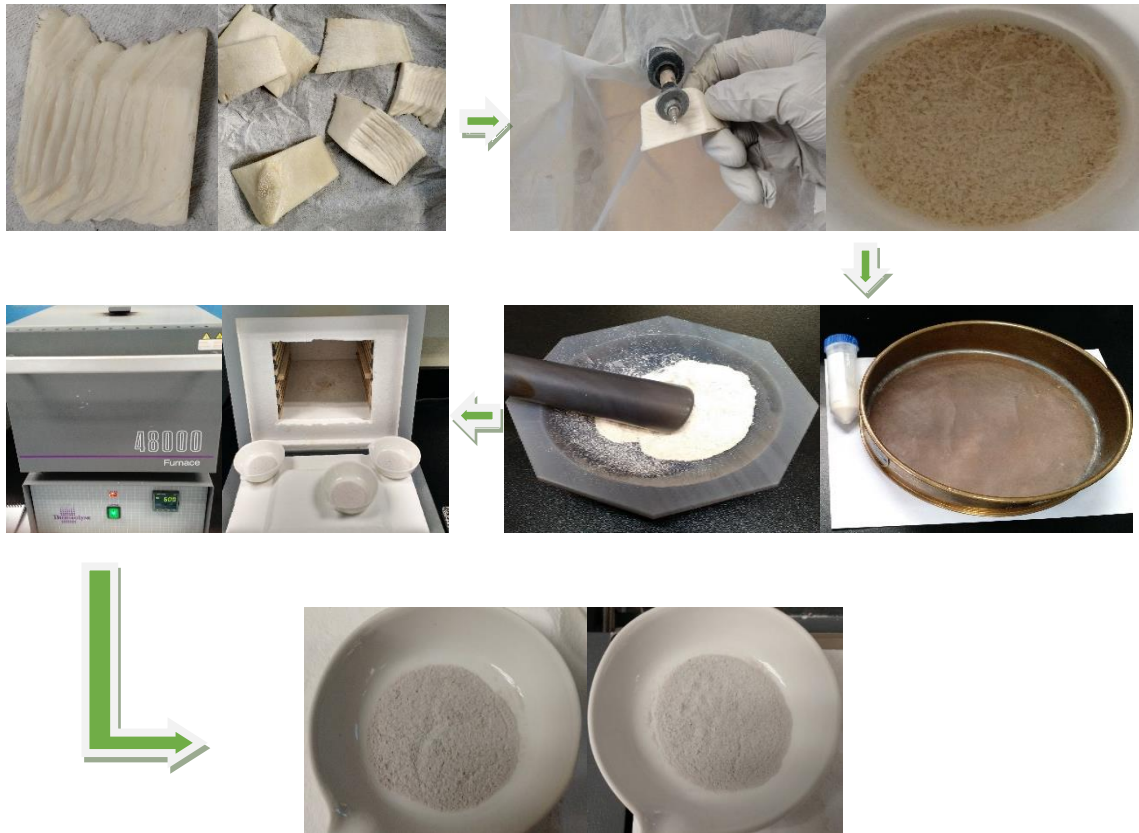
Fig. 18. Proceso de obtención de hidroxiapatita a partir de hueso bovino.
