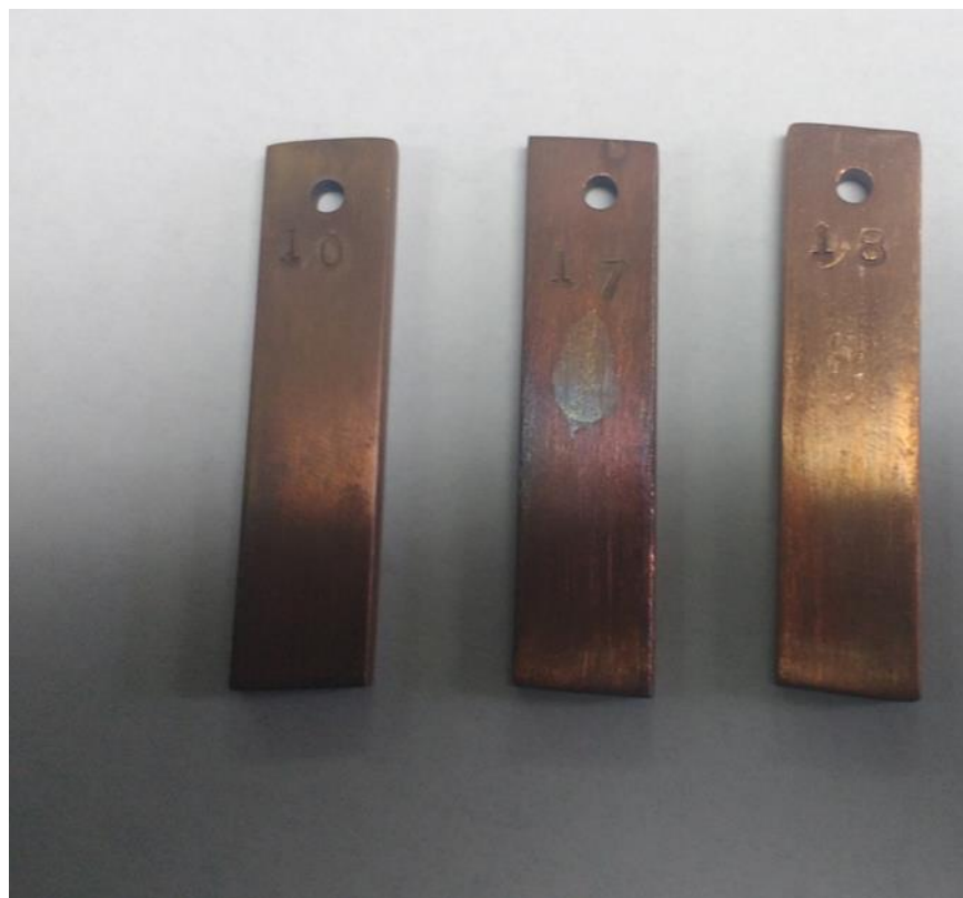
Figura 32. Piezas de cobre después de 840 h de exposición a biodiesel con extractos. De izquierda a derecha: B100, Pluchea seríceea, Larrea tridentata.
