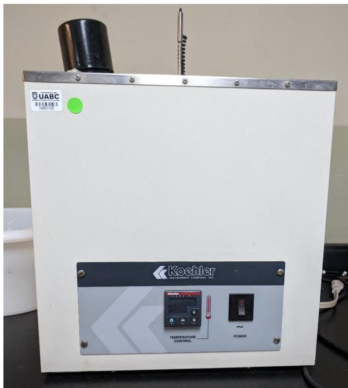
Figura 19. Baño térmico Koehler con control de temperatura y agitación.
