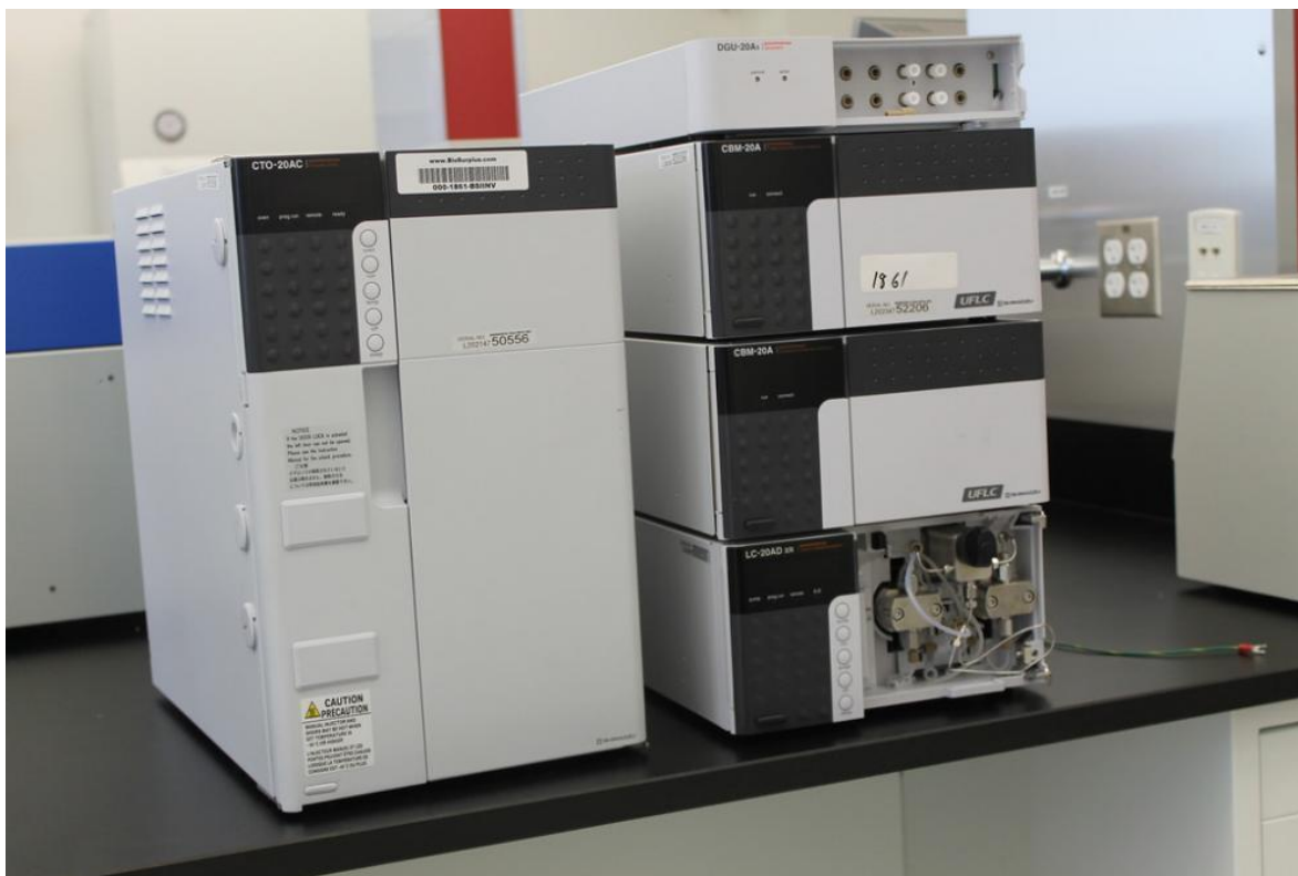
Figura 17. Cromatógrafo Shimadzu LC-20AD, equipado con un inyector SIL-20A/HAT.
