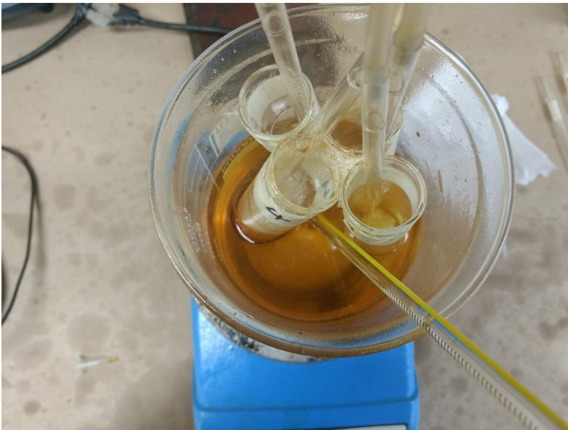
Figura 27. Montaje para el método del oxígeno activo.
