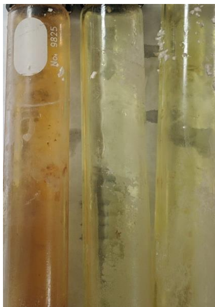
Figura 34. Apariencia del biodiesel con extractos expuestos a acero al carbono durante 840 h. De izquierda a derecha: Blanco, Pluchea sericea , Larrea tridentata .
