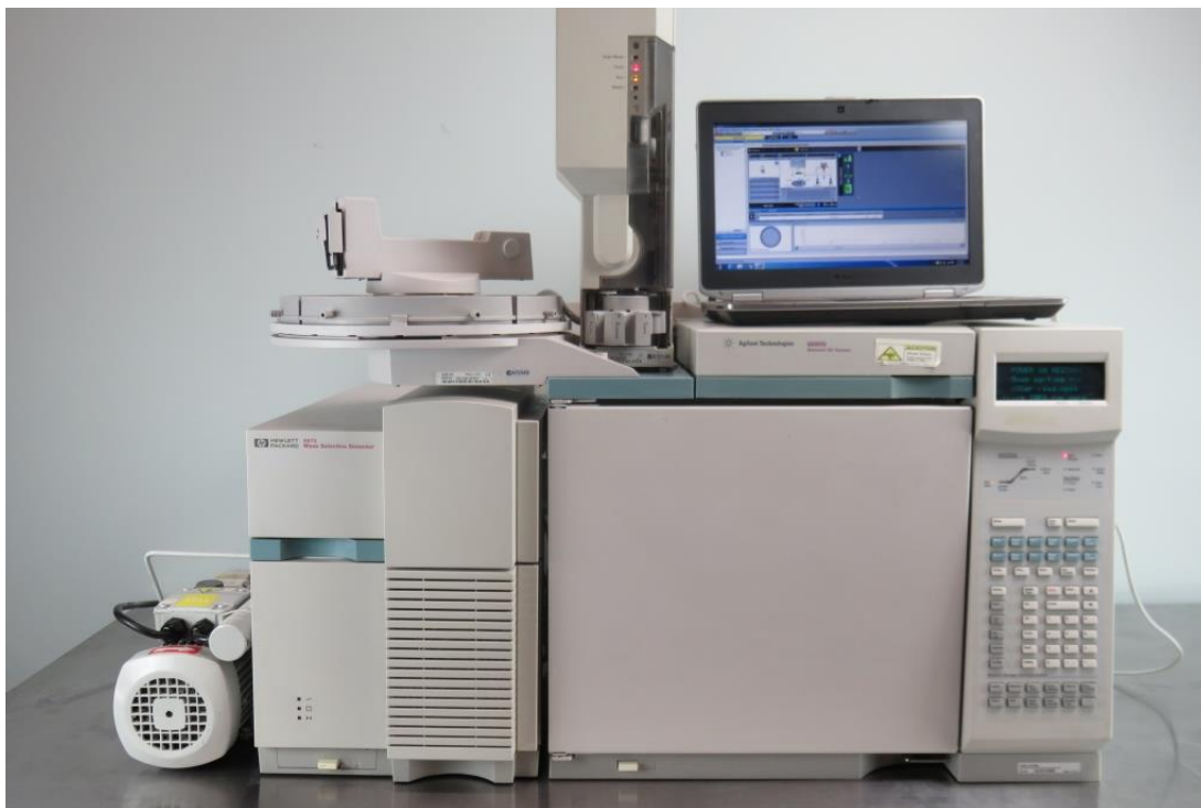
Figura 13. Agilent 6890N acoplado a un detector selectivo de masas modelo 5973N.
