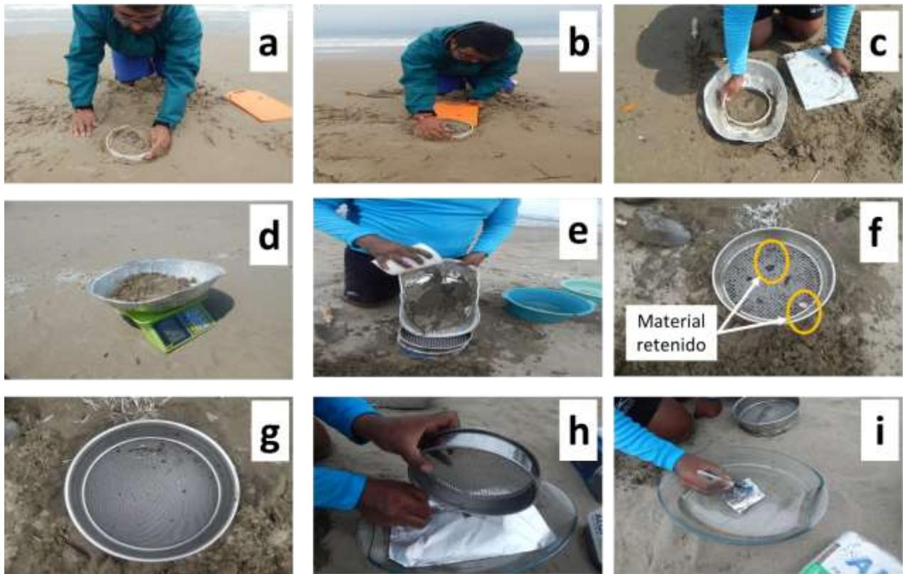
Figura 33 Metodología empleada para el muestreo de microplásticos. a) hundimiento del muestreador; b) segmentación de la muestra; c) deposición de la muestra en charola de aluminio; d) determinación de la masa de la muestra; e) enjuague de la muestra; f) retención de residuos en malla de 4.75 mm; g) retención de residuos en malla de 0.5 mm; h) vaciado de residuos en papel aluminio; i) rotulación de las muestras
