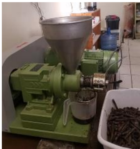
Figura 18. Extracción de aceite de jatropha.
