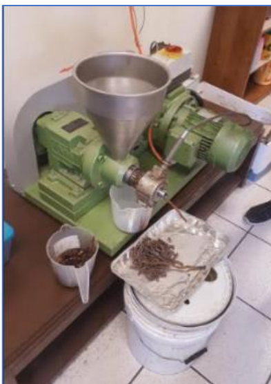
Figura 17. Extracción de aceite de higuera
