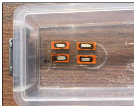
Figura 4.2.6.2. Resguardo de los sustratos con ITO/CdS/CdTe/Ag.
