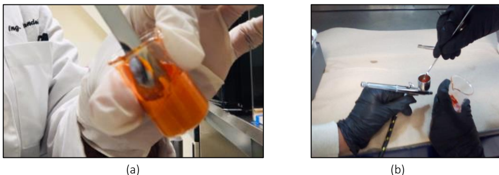
Figura 4.2.4.3. Preparación (a) y deposición de CdS en el aerógrafo (b).
