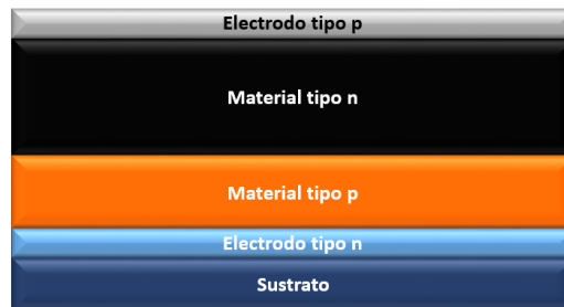
Figura 3.1.1. Estructura de una celda solar formada con heterounión.
