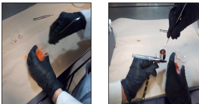
(a) (b) Figura 4.1.4.3. Preparación (a) y deposición de CdS en el aerógrafo (b).
