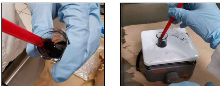
Figura 4.1.5.3. Preparación de CdTe
