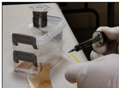
Figura 4.2.7.2. Estañado de puntas en los caimanes.
