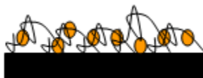
Fig. 3.8. OPH inmovilizada en un gel de quitosano sobre la superficie del transductor electroquímico.
