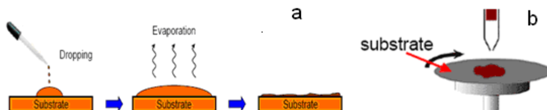
Fig. 3.9. A) Recubrimiento por goteo y B) recubrimiento por rotación.
