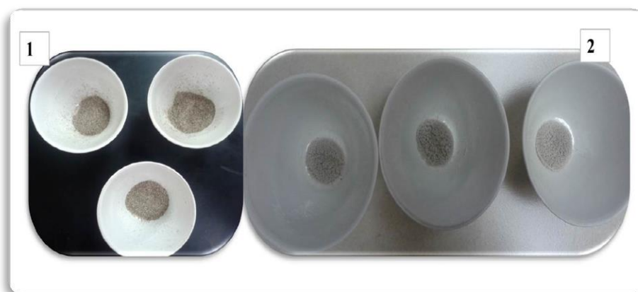
Figura 26. Muestras de podas de vid. 1: libre de humedad, 2: posterior al análisis de cenizas.
