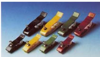
**Figura 3.8.** Electros de pinza muñeca/pierna de (AgCl).
