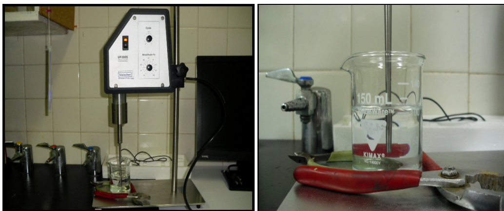
Figura 18. (Izquierda)Sonicador, a=0.7 ciclos y 25% de amplitud. (Derecha) Sonicando la suspensión precursora.
