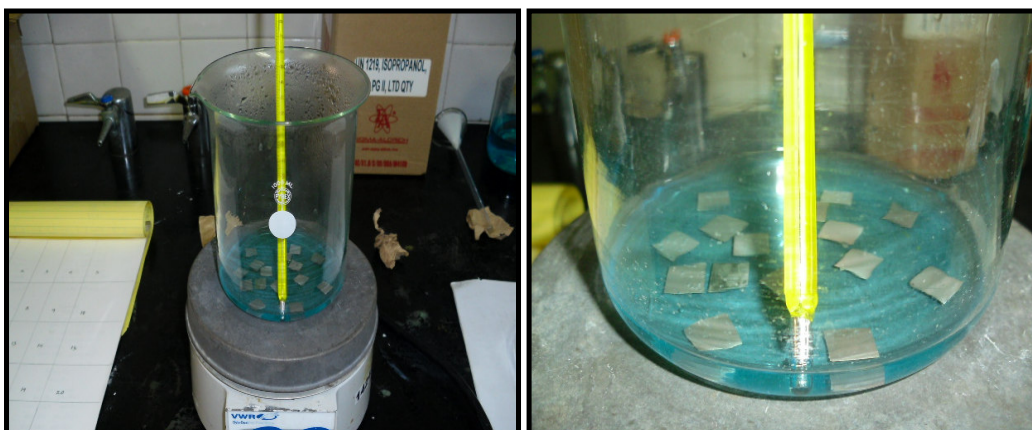
Figura 13. (Izquierda) Deposición química del óxido cuproso ( \text{Cu}_2\text{O} ) sobre las placas de cobre. (Derecha) Acercamiento al tratamiento químico.
