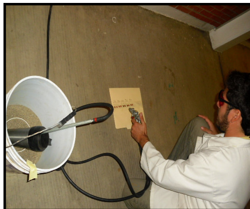
Figura 17. Baño de arena a presión sobre las muestras.
