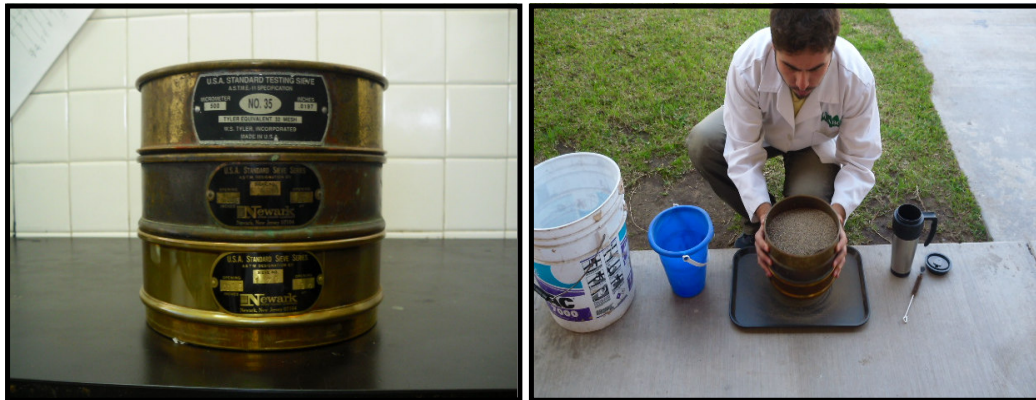
Figura 15. (Izquierda) Cernidores de 500, 63 y 9 \mu\text{m} . (Derecha) Se deposita cierta cantidad de arena, una y otra vez.
