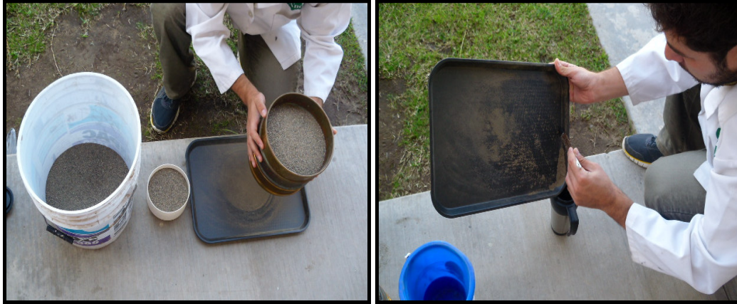
Figura 16. (Izquierda) Se cierne la arena con movimientos circulares hasta obtener arena muy fina. (Derecha) Se recoge la arena muy fina en un recipiente con ayuda de una brocha.
