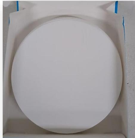
**Figura 23. Papel filtro con diámetro de poro de 110 nm.**
