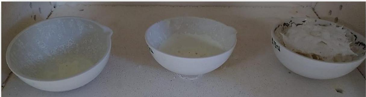
**Figura 37. Muestras después de la calcinación.**
