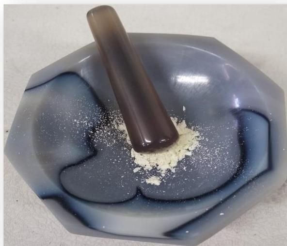
**Figura 38. Las muestras se llevaron a un mortero para ser trituradas.**
