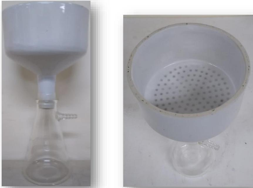
**Figura 24. Matraz Kitasato y embudo.**
