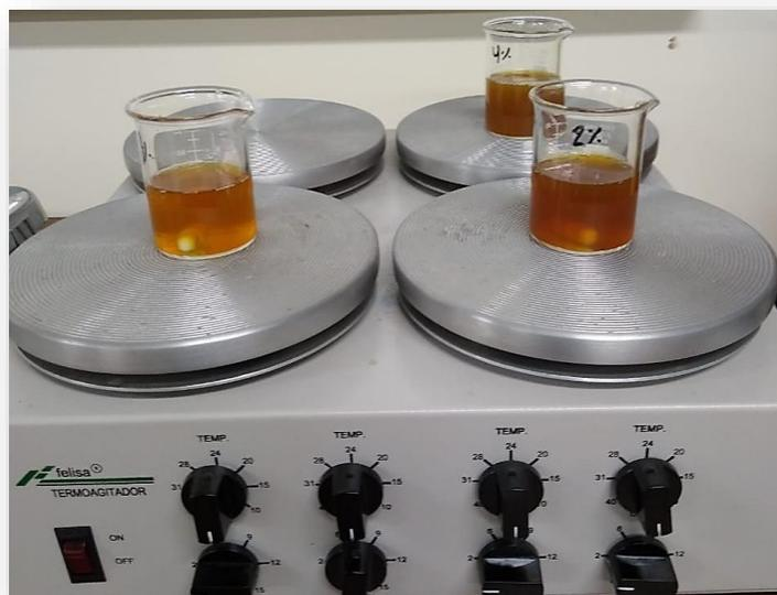
**Figura 31. Agitación del extracto de Orégano con los 2 gr de Nitrato de Zinc.**
