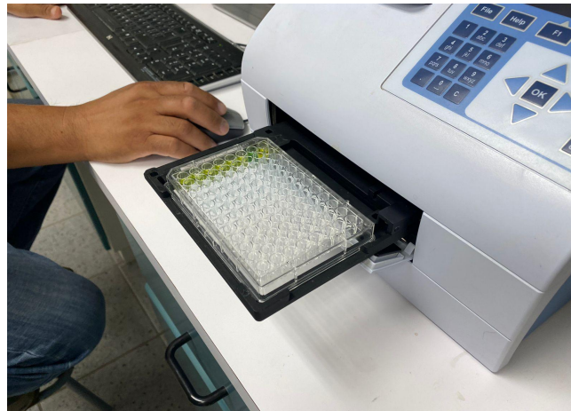
Figura 10. Lector de microplacas (Thermo Scientific Multiskan SkyHigh) con muestras de los organismos del bioensayo.
