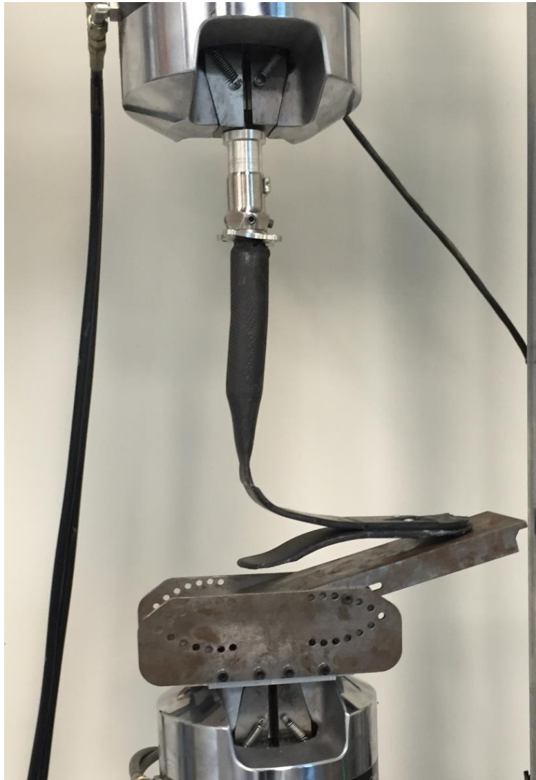
Figura 5.16 Prótesis montada en máquina para pruebas
