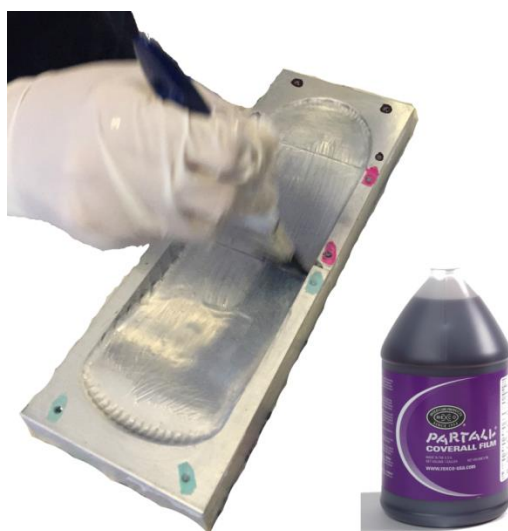
Figura 4.29 Aplicación de cera al molde en etapa de preparación del molde
