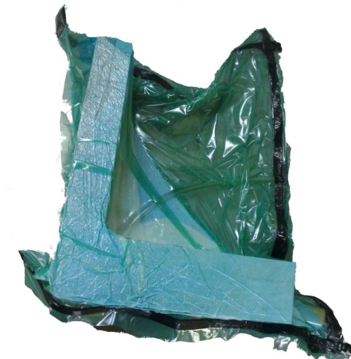
Figura 4.33 Molde superior cerrado, sellado y estrangulado al vacío previo a etapa de curado
