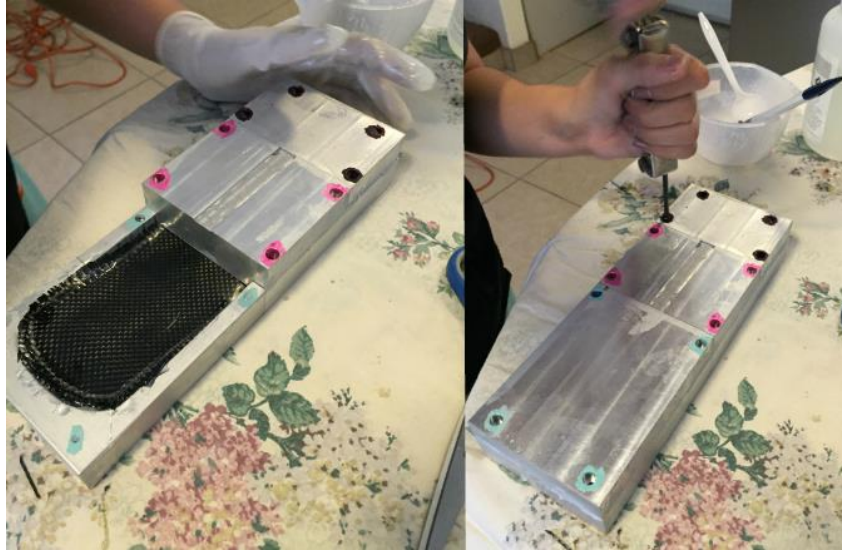
Figura 4.32 (Izq.) Colocando contrapartes en molde. (Der.) Cerrando molde con tornillos
