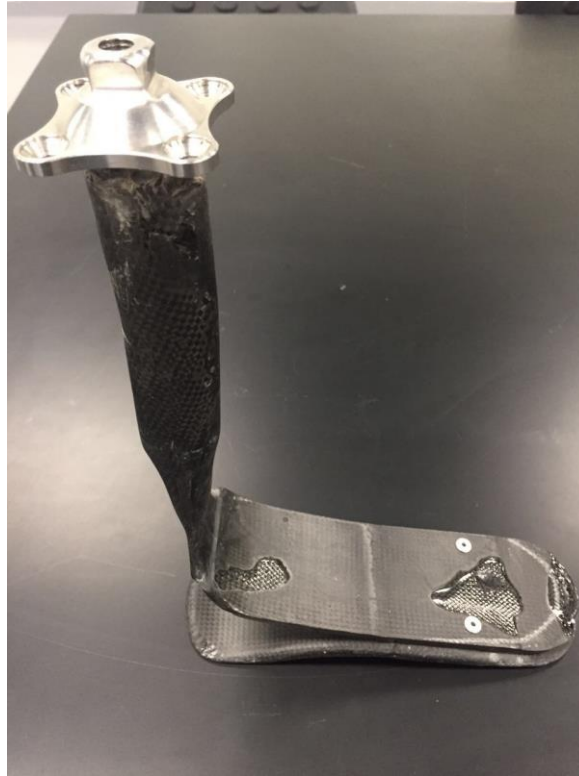
Figura 5.14 Prótesis transtibial con montaje para prueba
