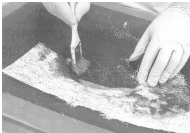
Figura 2.16 Moldeo de fibra de vidrio por colocación manual
