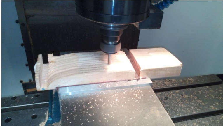
Figura 4.11 Pieza inferior de molde Rev. 2 siendo maquinada
