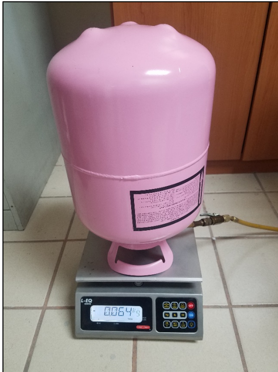
Figura 18. Recarga parcial de 10% de refrigerante en campaña #1.
