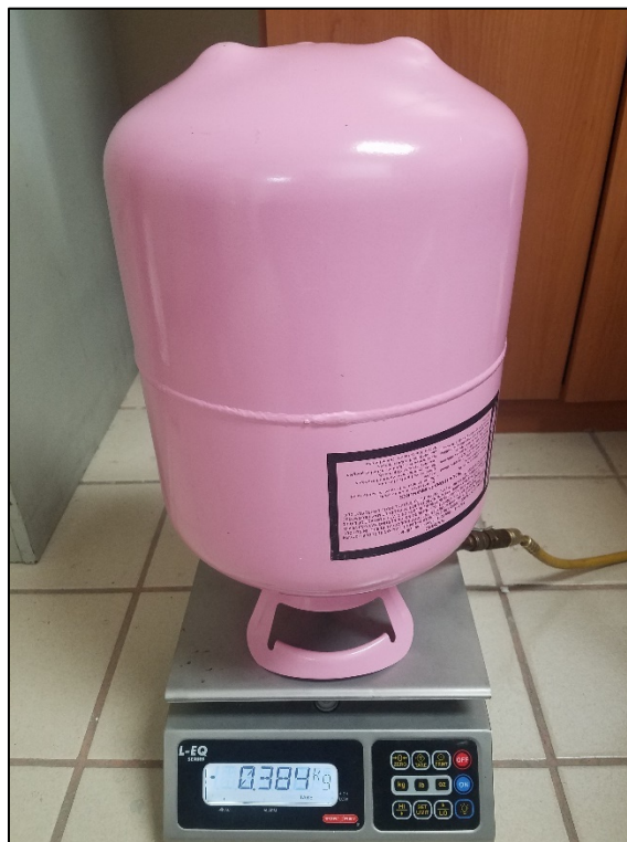
Figura 16. Recarga del 60% (0.384 kg) de refrigerante R410A en campaña #1.
