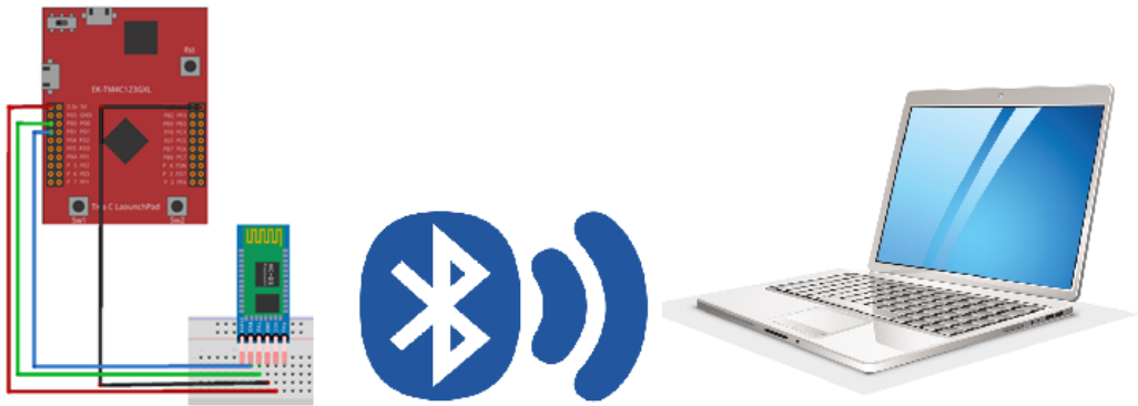
Figura 3.18 Transmisión inalámbrica de datos a partir de un microcontrolador con una señal senoidal almacenada en su memoria flash.
