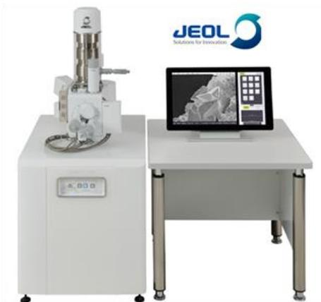
El microscopio electrónico de barrido - SEM- es el mejor método adaptado al estudio de la morfología de las superficies. A diferencia de un microscopio óptico que utiliza fotones del espectro visible, la imagen entregada por el SEM se genera por la interacción de un haz de electrones que "barre" un área determinada sobre la superficie de la muestra.
