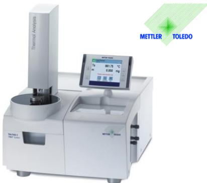
La termogravimetría es un método estándar de análisis de muestras orgánicas, inorgánicas y sintéticas en el que se mide la variación en el peso de una muestra después de que ésta ha sido sometida a una temperatura determinada.
