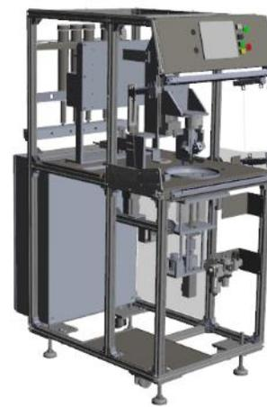
Fig 4 Máquina engrasadora de 5 agujas
