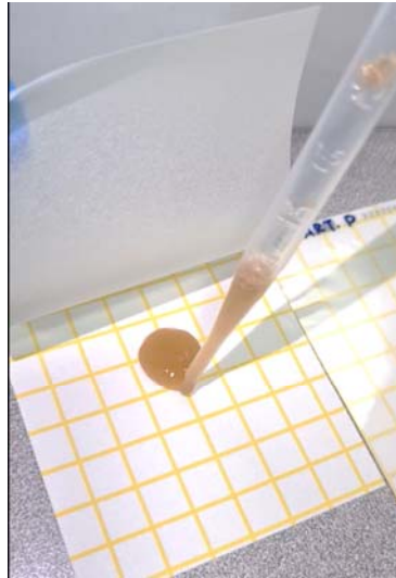
Figura 3.47. Hidratación de placa de mesófilos aerobios petrifilm 3M con 1mL de muestra.
