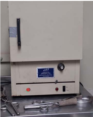
Estufa de 103 a 105°C. desecador con botes vacíos y secos. Peso de muestra de suelo húmedo.
