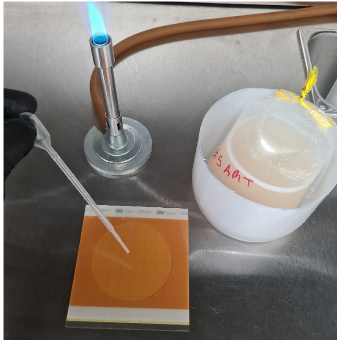
Figura 3.40. Placa 3M Petrifilm SALX sobre una superficie plana.
