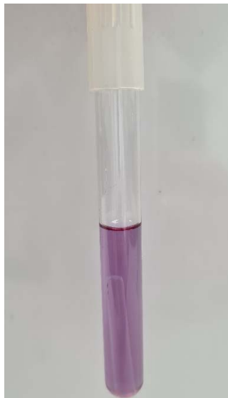
Tubo con medio CLT y púrpura de bromocresol sin fermentación.
