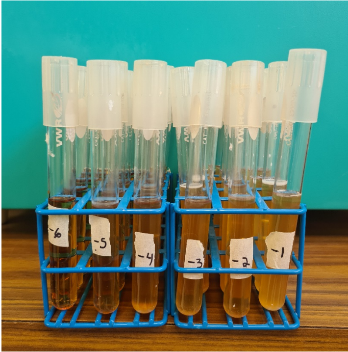
Figura 3.16. Tubos con medio CLT estéril para inoculación de muestras.
