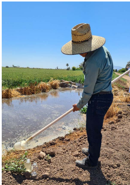
Figura 3.8. Muestreo de agua en botella Winkler para análisis de OD.
