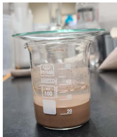
Termino de mezcla de muestra dejándose reposar 15min
