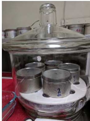
Estufa de 103 a 105°C. desecador con botes vacíos y secos. Peso de muestra de suelo húmedo.
