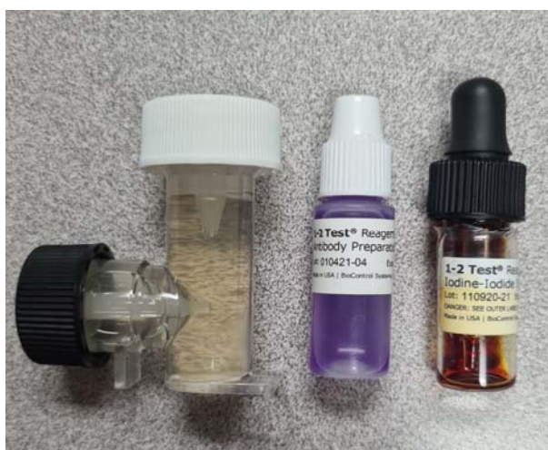
Figura 3.23. Prueba 1,2 test, anticuerpo y solución Iodo-Ioduro
