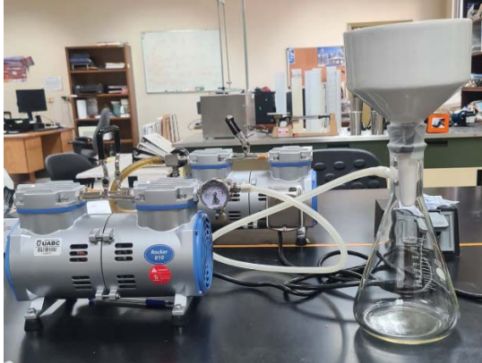
Equipo de extracción instalado.
