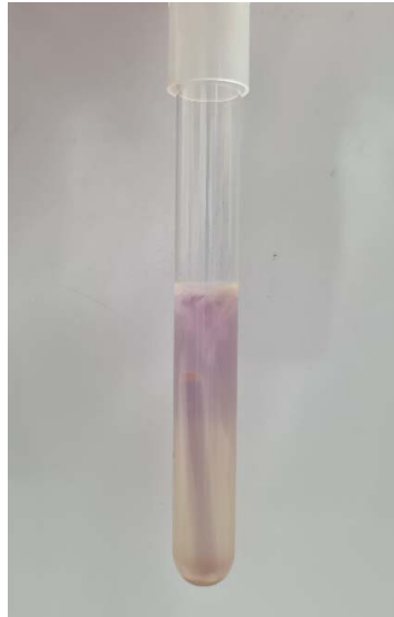
Tubo con medio CLT y púrpura de bromocresol con acidificación del medio.
