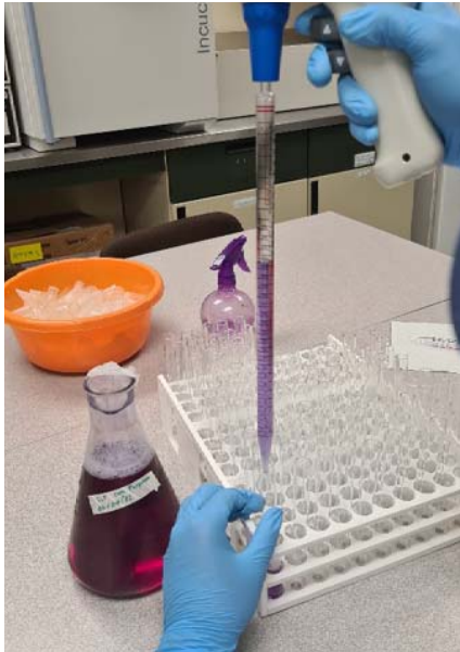
Preparación de CLT con púrpura de bromocresol
