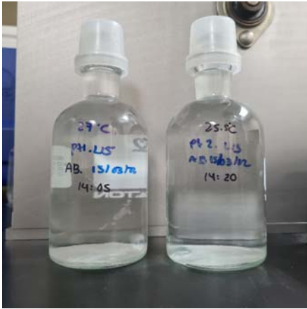
Figura 3.9. Muestras de agua en botellas Winkler. Figura 3.10. Conservación de muestras.
