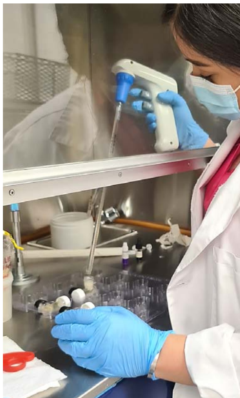
Figura 3.24. Prueba 1,2 test siendo inoculada con 0.1mL de muestra.
