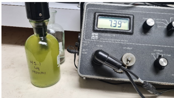
Figura 3.29 Lectura de OD en equipo YSI 58 en laboratorio.
