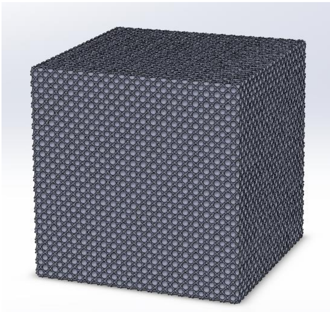
Figura 4-16 Modelado 3D de la espuma de carbono
