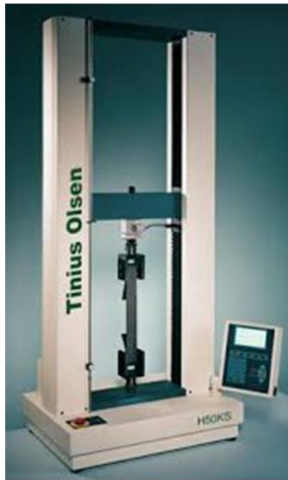
Figura 4-3 Equipo de ensayos universal para pruebas mecánicas
