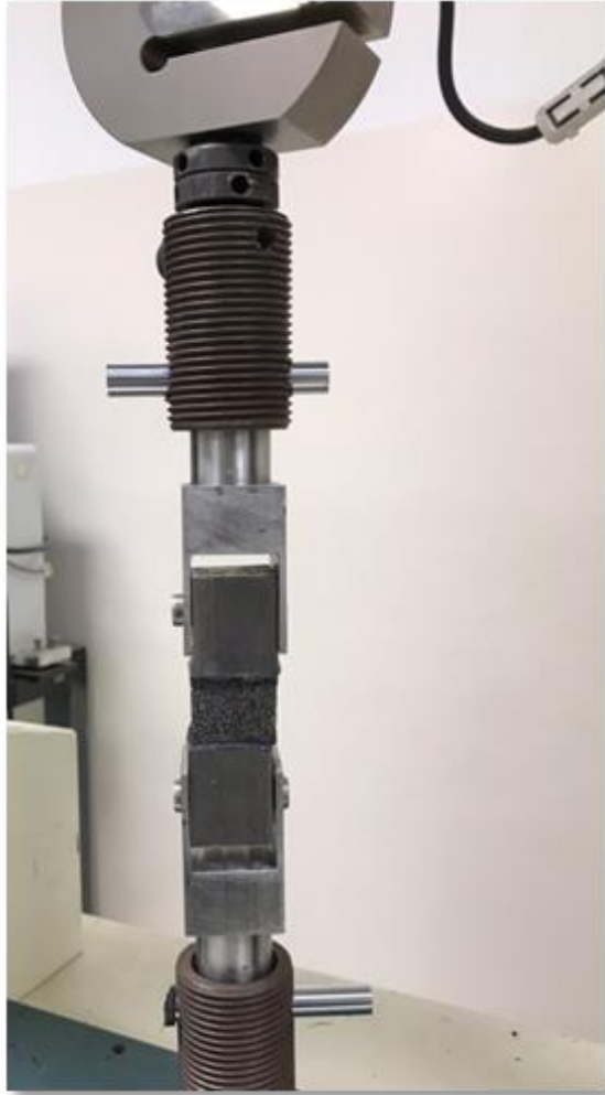
Figura 4-12 Montaje para ensayos de tensión
