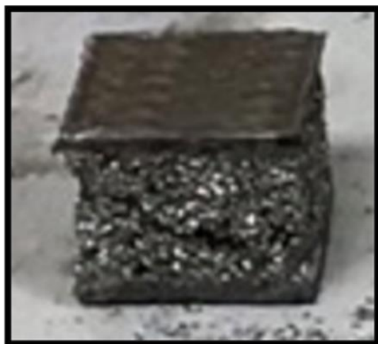
Figura 5-13 Modo de falla a compresión en ensayo para CFOAM 20
