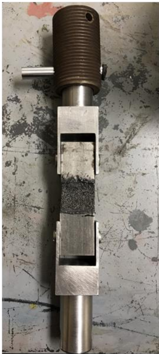
Figura 4-11 Ensamble de probeta a tensión
