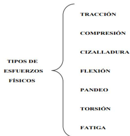
Figura 3-2. Tipos de esfuerzo en estructuras.
