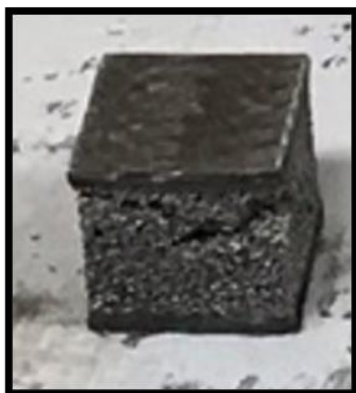
Figura 5-17 Modo de fallo a compresión en CFOAM 25
