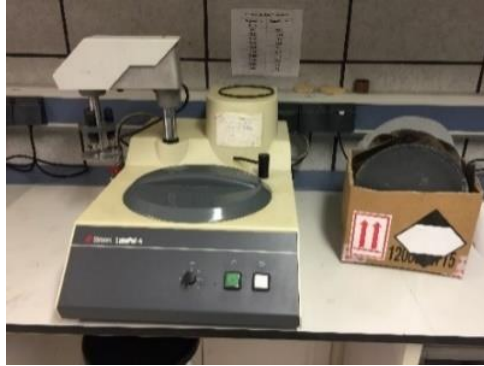
Figura 3.17. Equipo para pulir superficies del vidrio
