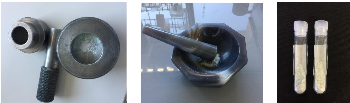
Figura 4.1. Preparación de 1 gramo muestra para análisis de XRF
