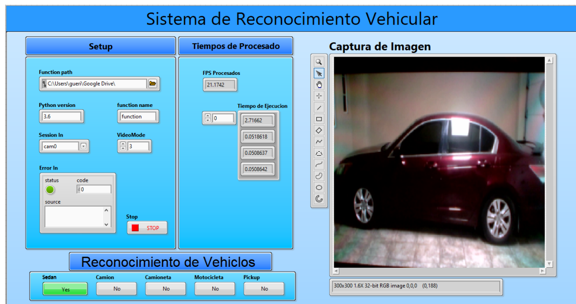
FIGURA 3.12: Interfaz de usuario para el Sistema de Reconocimiento Vehicular, donde se observa que se está capturando una imagen de prueba de un vehículo de clase sedán y es confirmado por la CNN de clasificación
