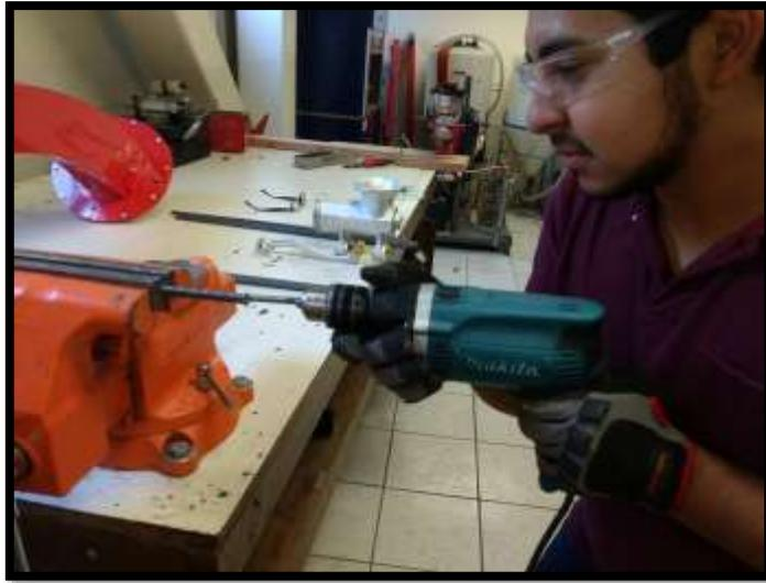
Después se procedió a realizar la conexión en el orificio utilizando como adherente epóxico, introduciendo el cable eléctrico No. 12 en el orificio. Se colocó cinta adhesiva para cubrir con pintura anticorrosiva el área de la varilla que quedaría fuera del espécimen de concreto, y el área de que estaría embebida en concreto sin protección.
