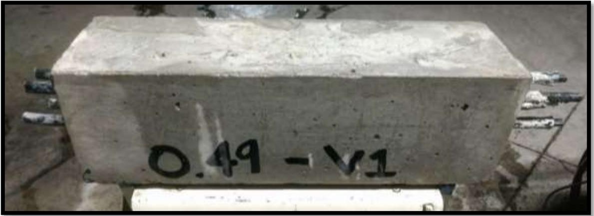
Se utilizó un tripie para sostener el electrodo de (CuSO<sub>4</sub>) calomelanos, sobre una esponja mojada con el agua destilada, colocado en el centro de una de sus caras longitudinales, conectando el positivo en la varilla a evaluar y el negativo al contacto del electrodo. Esperar unos minutos a que establezca la numeración que nos indicara la cantidad de mV que emite el acero.
