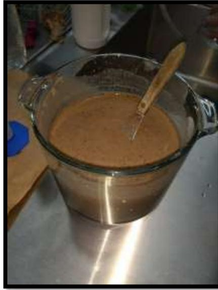
Se realizarán dos mezclas una de porción de tierra con agua destilada a 0.50 m y 1.00 m de profundidad del área de terreno donde enterraran los especímenes de concreto. En proporción se agregarán 1.30 lt de agua por 187 g de tierra. La mezcla se hará con el fin de obtener los iones de las mismas, en una solución acuosa que se procederá a medir la cantidad de solidos disueltos totales.
