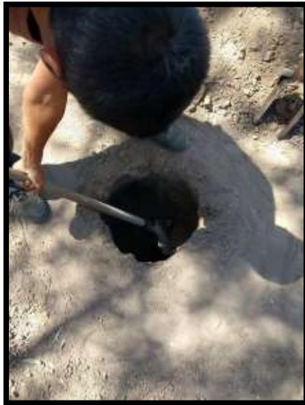
Se extrajeron dos muestras de tierra a 0.50 m y 1.00 m de profundidad del área de terreno en donde se enterraron los especímenes, se realizó la prueba de resistividad, prueba del pH, el contenido de sólidos disueltos totales y contenido de cloruros.
