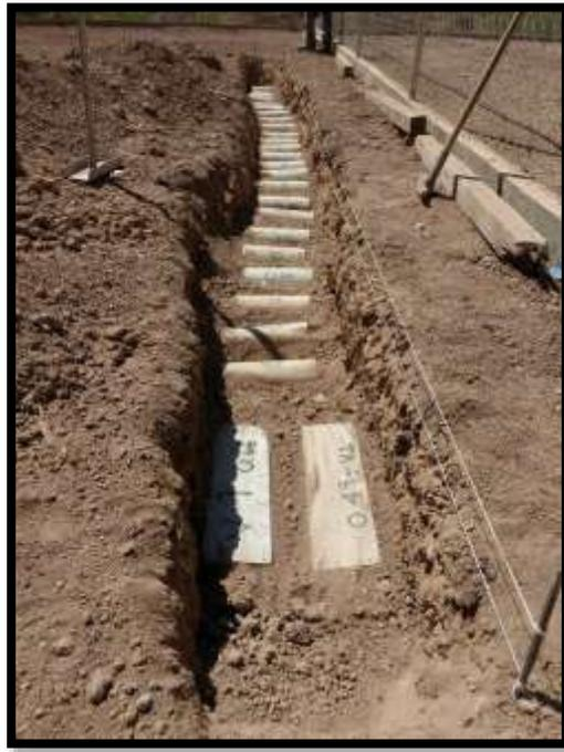
El orden fue expuesto de modo que el cilindro #1 de relación agua-cemento 0.66 y el #1 a/c 0.49, quedaran como especímenes vecinos y así consecutivamente hasta los cilindros #12 de los tipos de concreto. Las varillas se colocaron en los extremos de la zanja para identificar el sitio donde se encontraban los siguiente cilindros a analizar.
