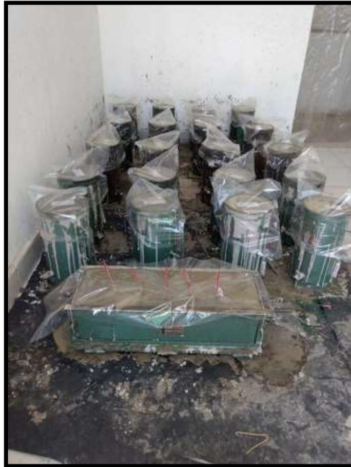
El curado de los especímenes se realizó sumergiendo en su totalidad los especímenes en piletas de agua con cal durante 28 días, tiempo en el que se espera que el concreto alcance su curado y cumpla con la resistencia para el que fue diseñado.
