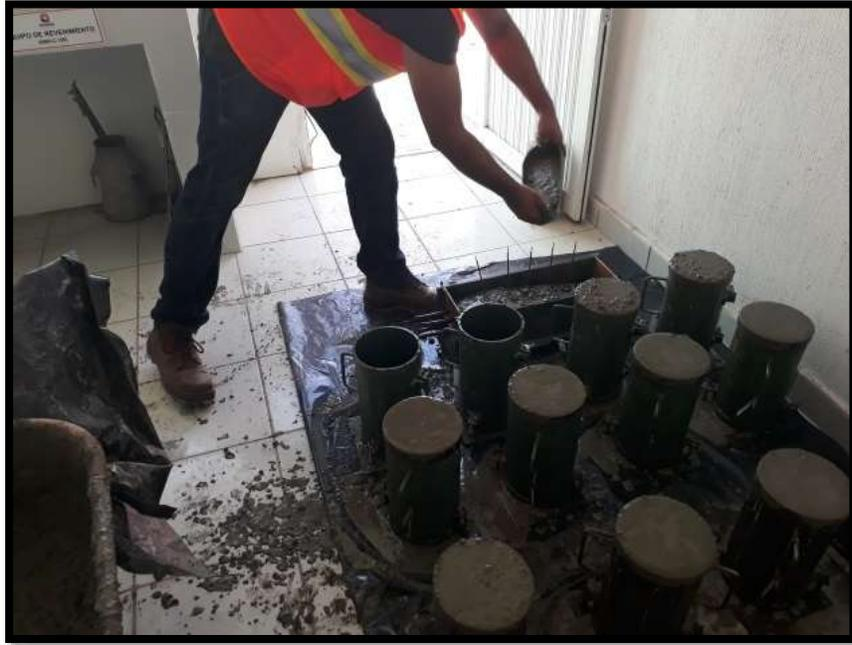
El llenado de los moldes cilíndricos y del tipo viga fue directo sin realizar ninguna operación de varillado o martilleo para eliminar el contenido de aire ya que este concreto es auto compactable y su agregados se estabilizan por si solos. Al ser llenado se enrazo con varilla de enrase, se les identifico con una etiqueta y se les coloco plástico para el proceso de curado.
