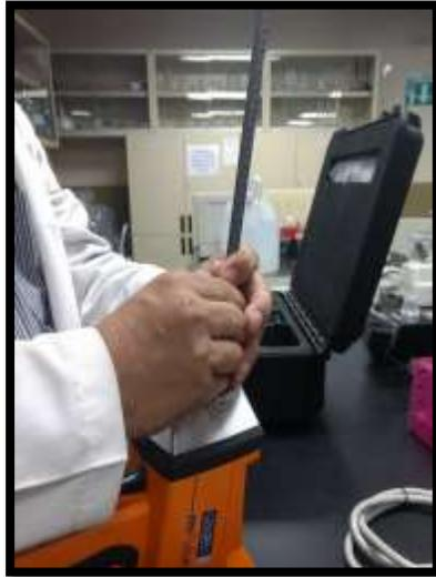
**Figura. 3.5** Análisis de varilla 1/4" (alambrón) por medio de Espectroscopia de Inducción por rompimiento laser LIBS.
