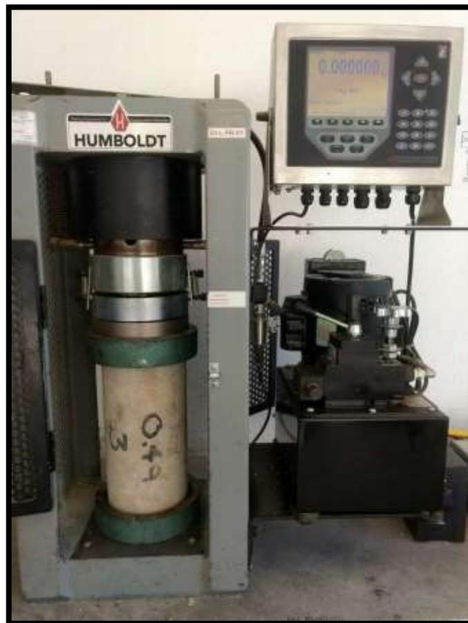
**Figura. 3.33** Finalización de prueba de resistencia a la compresión de cilindro a/c 0.66.
