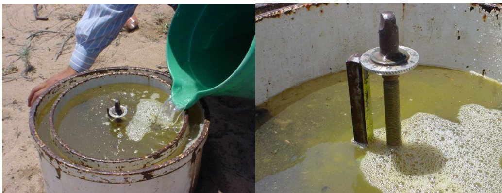
Figura 7. Infiltrómetro de doble anillo.
