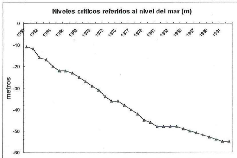
Anexo 4. Abatimiento en metros con respecto al nivel del mar del manto acuífero en la Costa de Hermosillo durante el período 1960-1992 (datos de Moreno, 2000).
