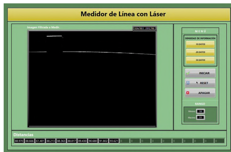
FIGURA 3.14: Programa que calcula la distancia en centímetros de la reflexión del láser de línea, que tiene opciones sobre la densidad de información a conocer, y un apartado para controlar el funcionamiento del programa.
