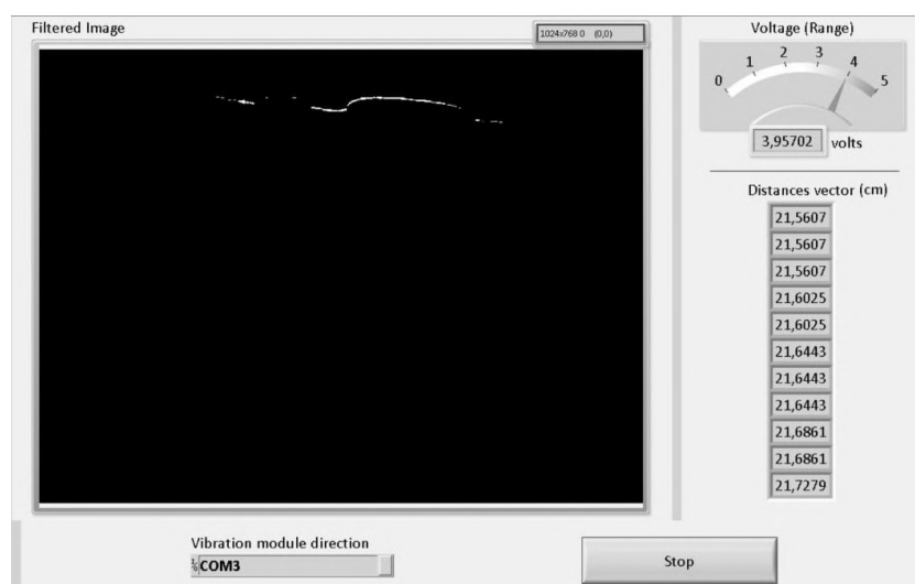
FIGURA 4.8: Programa que se observa en el cuadro negro lo que ve la cámara sobre la reflexión del láser en la superficie, en el lado derecho un vector en centímetros sobre las distancias que se calculan y un rango de voltaje siendo lo que entrega a la retroalimentación háptica para brindar el aviso al usuario.
