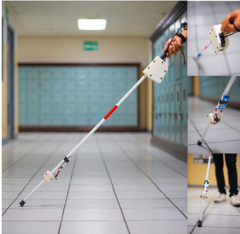
FIGURA 3.16: Prototipo final con la colocación de los componentes en el bastón guía.
