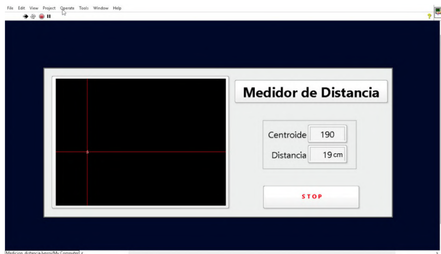
FIGURA 3.8: Programa que muestra el pixel del centroide de la información y el resultado del calculo de la distancia de la reflexión del láser, en el lado izquierdo lo que observa la cámara y dos líneas que interceptan la ubicación la reflexión del láser.
