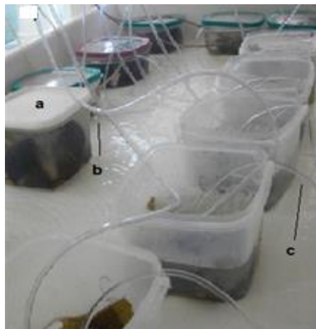
Fig. 2. Sistema de cultivo con flujo abierto: a) Reservorio, b) manguera de agua conectora, c) filtración, d) tubería.
