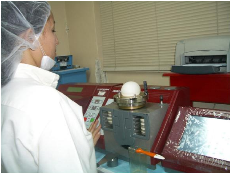
Figura 1. El alveógrafo permite determinar el comportamiento que va a tener la harina en las diferentes etapas del proceso de panificación.
