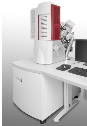
Figura 3.4: Equipo FIB/SEM LYRA marca TESCAN.
