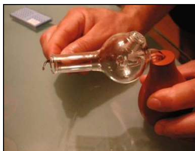
Figura 17. Muestreo por pipeteo sobre rejilla para MET
