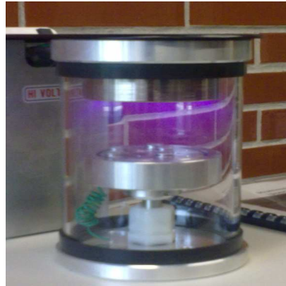
Figura 20. Recubrimiento de película conductora de oro por medio de sputtering.
