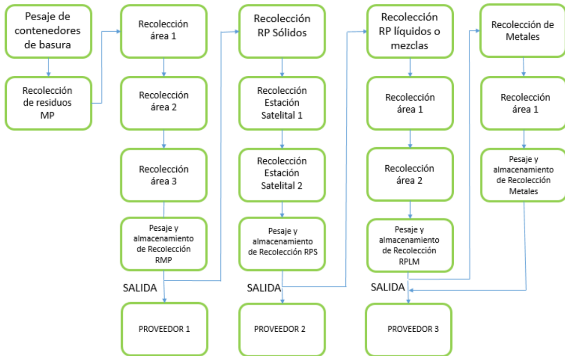
Figura 7. Diagrama de flujo que muestra la ruta de la recolección y transporte de residuos dentro de la planta.
