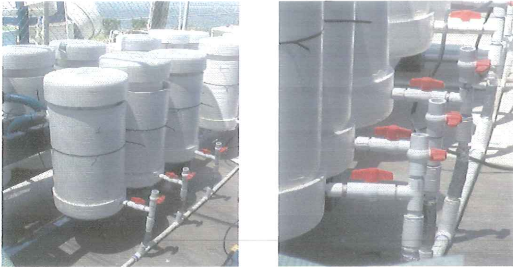
Figura 10. Unidades de surgencia del sistema de recirculación para el cultivo de M. mercenaria .
