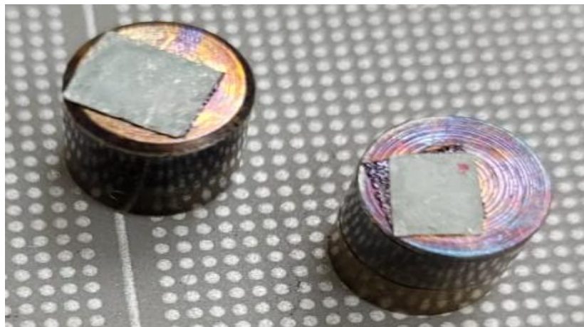
Figura 34. Recubrimiento en baño de oro puesto que el PVA es un polímero que no es conductor.
