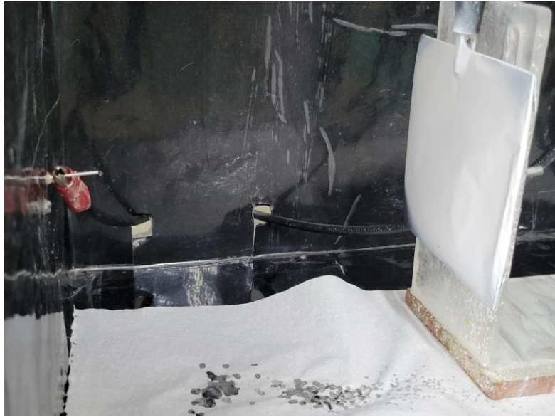
Figura 9. Proceso de formación de nanofibras por medio de campo eléctrico.
