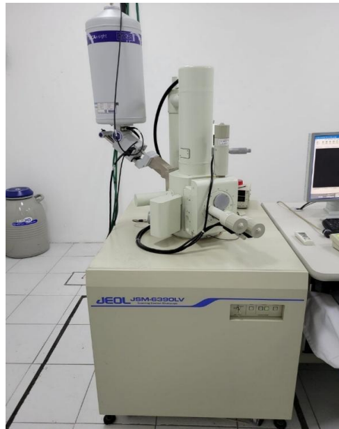
Figura 8. Microscopio electrónico de barrido donde se analizaron las muestras.
