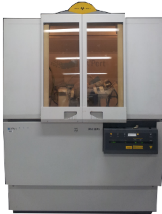
Figura 4.4: Difractómetro utilizado modelo Philips X'pert MPD (XRD), utilizado para obtener los patrones de DRX de las muestras para el estudio de caracterización.
