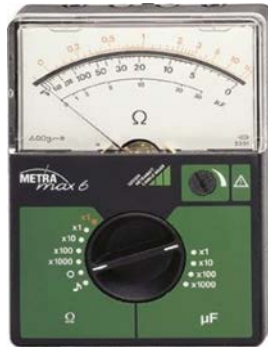
Figura 1. Óhmetro analógico marca Gossen-Metrawatt modelo METRAMax 6. Tomado de (ITM instruments Inc., s.f.).
