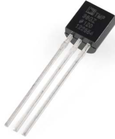
Figura 12. Sensor desarrollado por Analog Devices modelo TMP36. Tomado de (MCI Electronics, s.f.).
