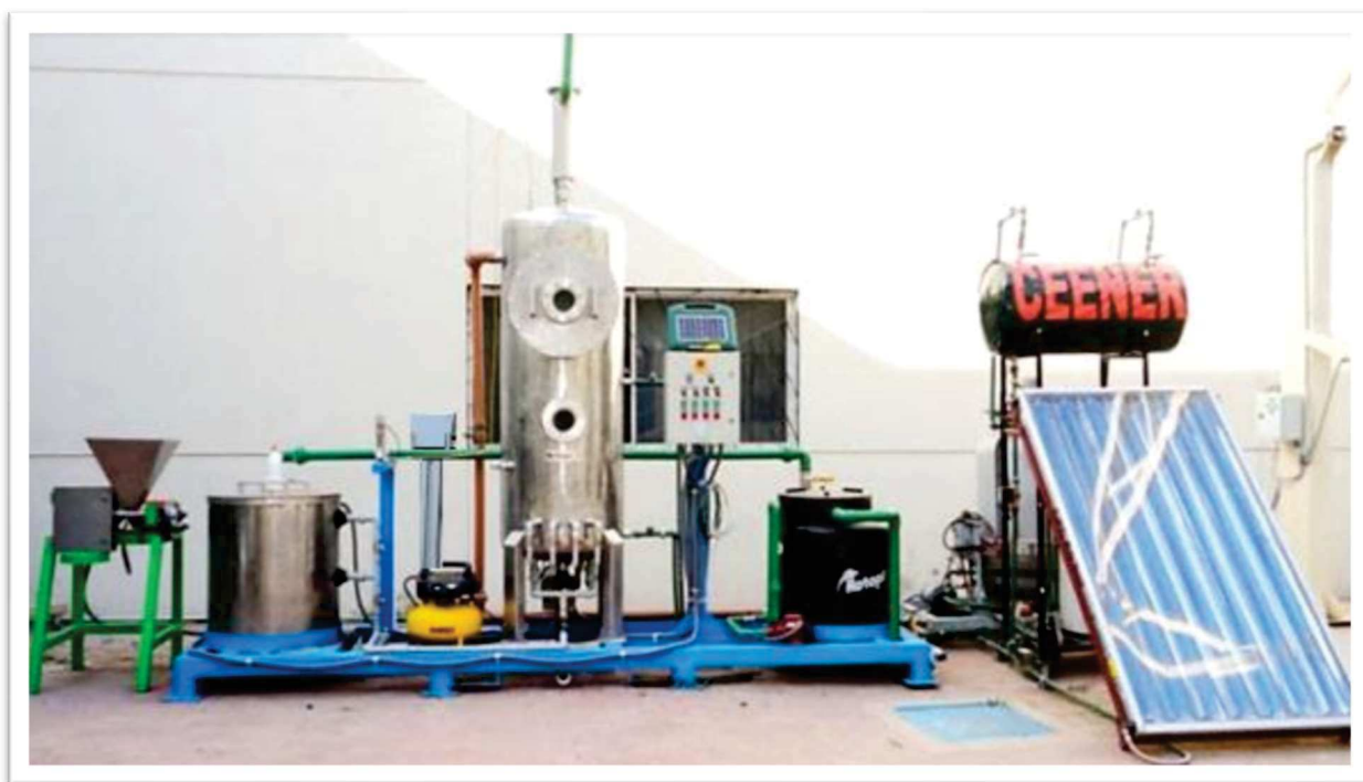
Figura 4. 27 Biodigestor anaeróbico. Fuente: Elaboración de Dra. Mydory Oyuky Nakasima López (Nakasima et al., 2015).
