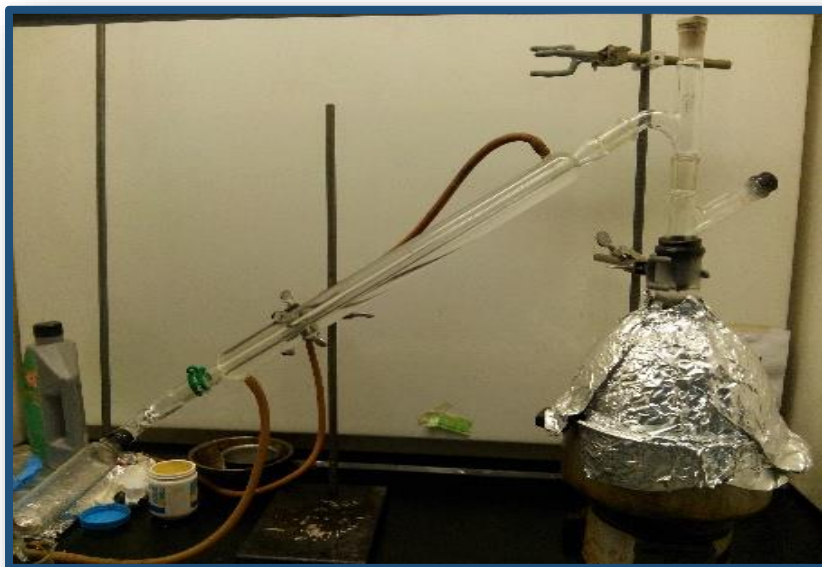
Figura 20: sistema de hidrodestilación por arrastre de vapor.
