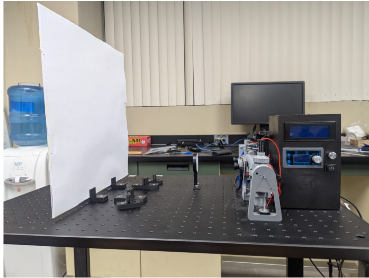
Figura 4.21: Disposición del equipo en la mesa óptica para la calibración extrínseca.
