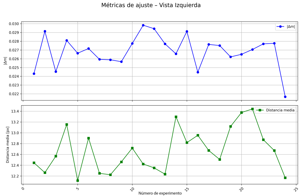
Figura 4.13: Evaluación de inclinación y alineación de espejos después del ajuste, vista izquierda.
