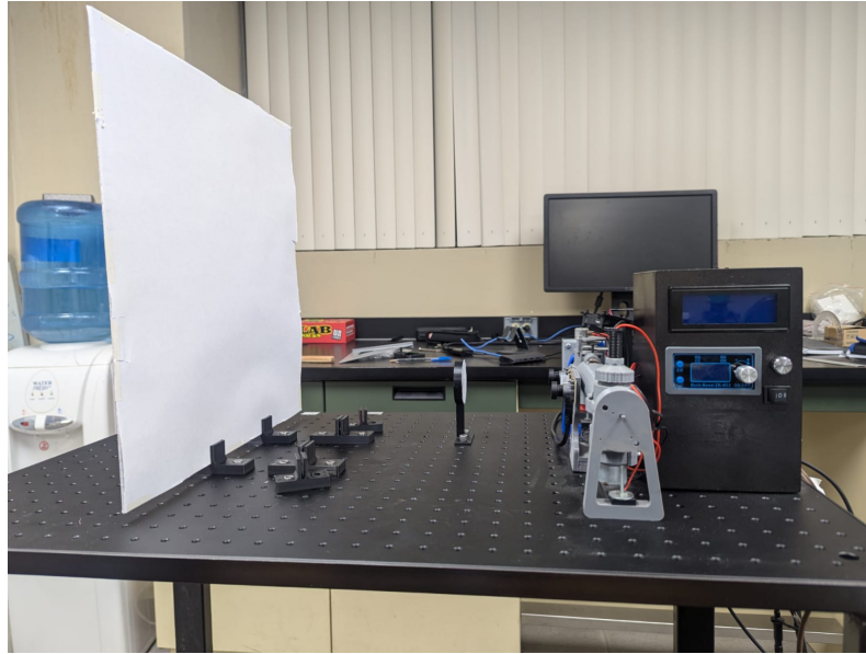
Figura 4.3: Configuración experimental con el TVS, el sistema estéreo y el patrón plano montados sobre una mesa óptica.
