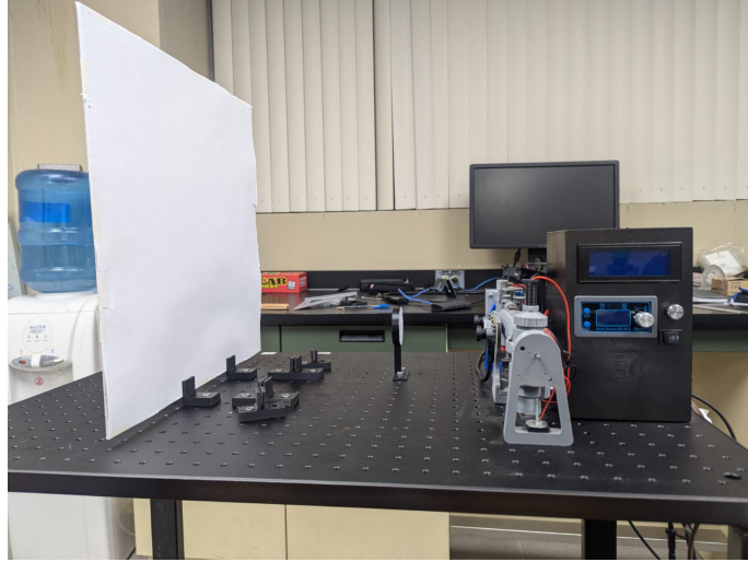
Figura 3.3: Ubicación de la superficie, que se asume como plana, dentro del campo de visión compartido por el sistema estéreo y el TVS.
