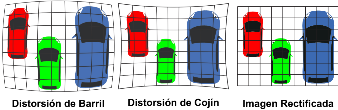
Figura 2.10: Ejemplo del efecto de la distorsión radial sobre una imagen y su corrección mediante rectificación.
