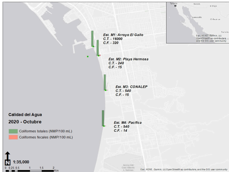
Figura 25. Distribución espacio-temporal de Coliformes totales y Coliformes fecales . en el periodo 2020 para los meses de septiembre y octubre en la Bahía de Todos Santos. Las barras rojas/verdes representan el NMP / 100 ml en cada estación de muestreo. Los mapas fueron generados a partir de capas del Sistema de Información Geográfica, se elaboraron con el programa ArcMap en una escala de 1:120,000. La longitud de las barras no representa una escala normativa, sino una escala relativa diseñada para facilitar la comparación espacial entre estaciones.
