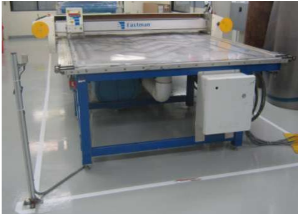
Figura 13. Máquina de corte automático de material pre-preg.
