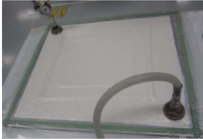
Figura 11. Prueba de vacío en un laminado.
