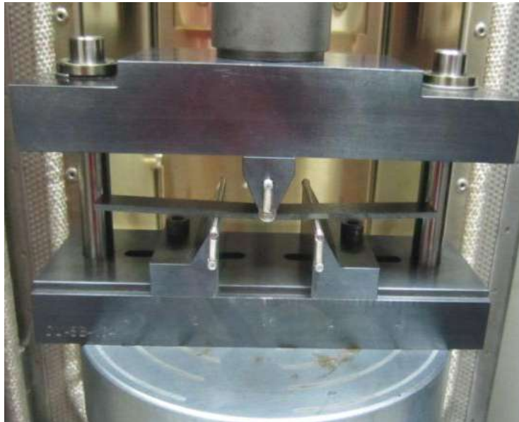
Figura 38. Especimen colocado en accesorio para prueba de flexión.
