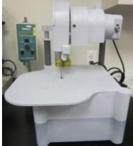
Figura 17. Sierra estacionaria banda de corte de diamante.
