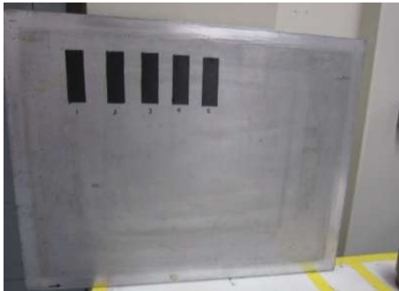
Figura 20. Especímenes durante prueba de adherencia de material pre-preg.
