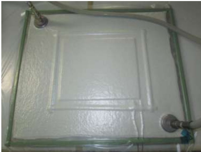
Figura 31. Colocación puertos de vacío.
