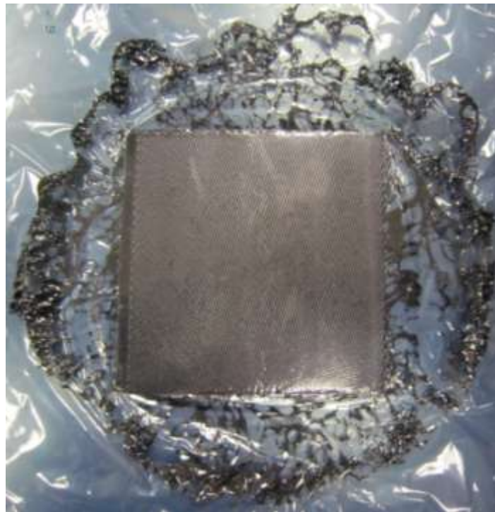
Figura 23. Espécimen después de una prueba de flujo de resina.
