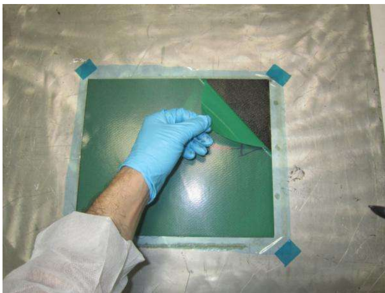
Figura 26. Moldeo material pre-impregnado.
