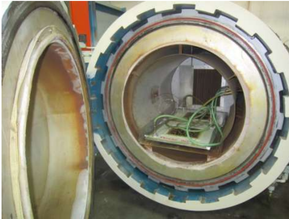
Figura 14. Procesamiento de paneles de prueba en Autoclave.
