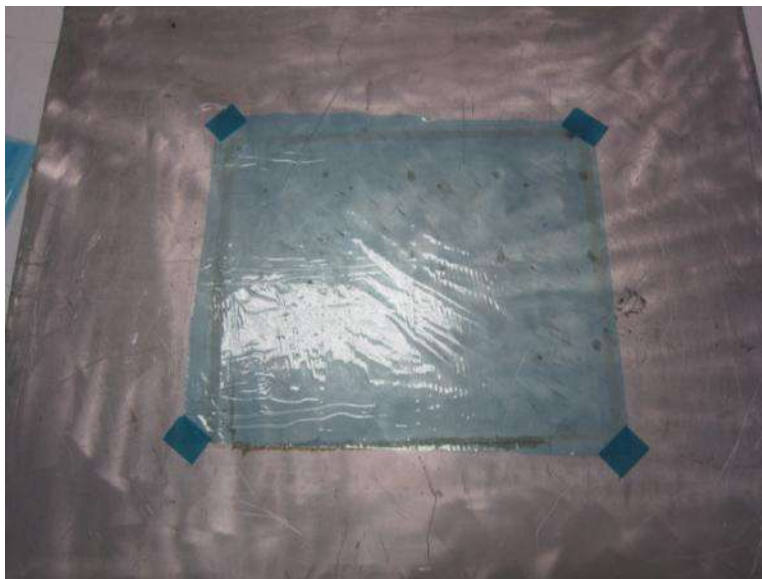
Figura 25. Colocación Plástico Antiadherente.
