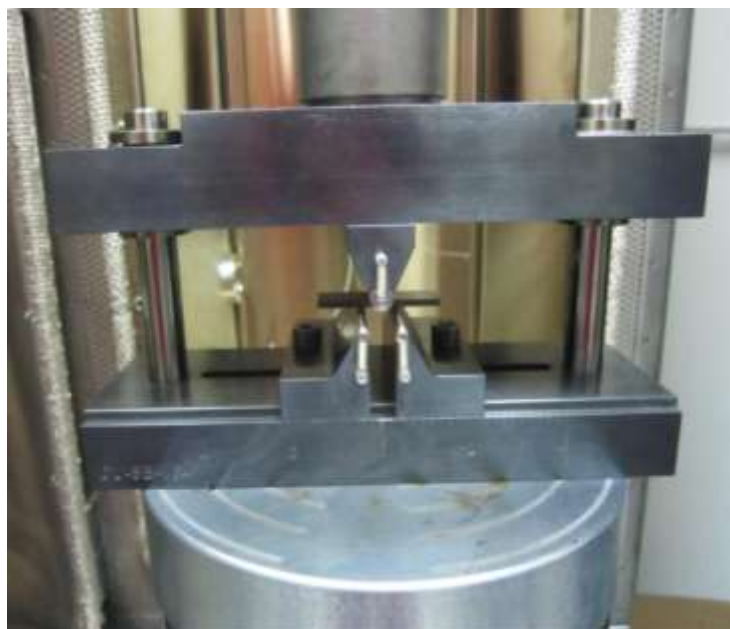
Figura 37. Espécimen colocado en accesorio para prueba de corte.
