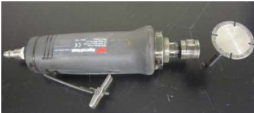
Figura 18. Cortador neumático manual con disco de carburo.
