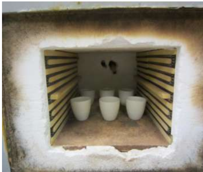
Figura 39. Especímenes colocados en crisoles dentro de la mufla.
