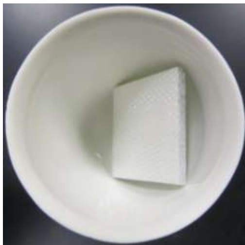
Figura 40. Especímenes después de la prueba de contenido de resina.
