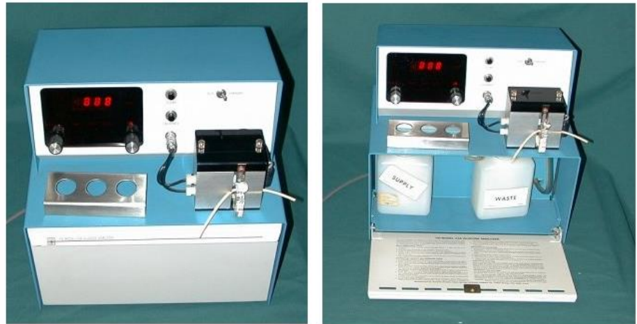
Figura 17: Medidor de glucosa YSI modelo 23A; 115V, 60Hz, 0.5A
