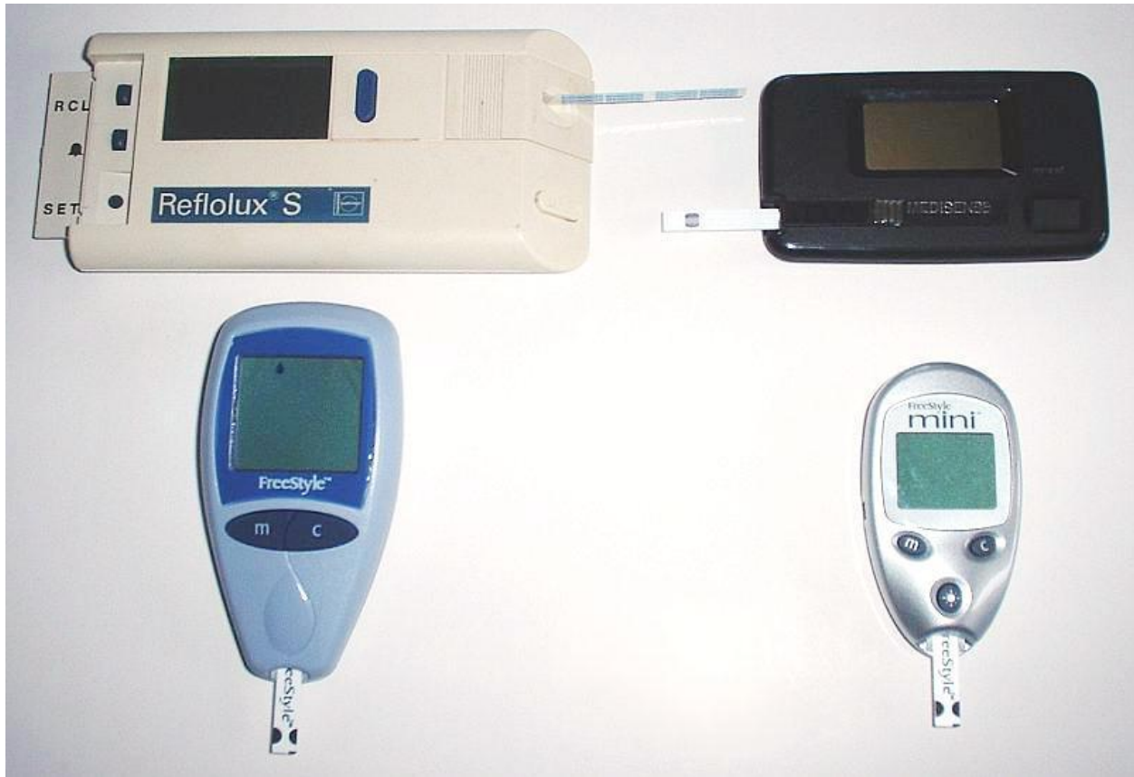
Figura 18: Cuatro generaciones de medidor de glucosa en sangre, 1993-2005 de derecha a izquierda. Los tamaños de muestra varían desde 30 hasta 0,3 \mu\text{L} . Los tiempos de prueba varían de 5 segundos a 2 minutos.
