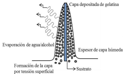
Figura 55: Proceso de gelación durante el la inmersión obtenido por la evaporación del solvente.
