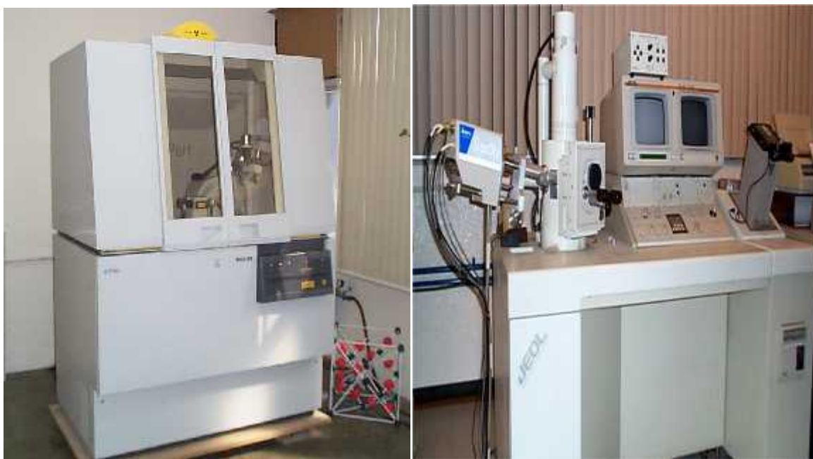
Figura 22. Difractómetro de rayos-X Philips X'Pert (derecha) y microscopio electrónico de barrido JEOL 5300 JSM (izquierda).
