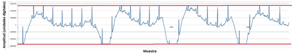
Figura 3.4 Señal de ECG muestreada a 180 Hz con ganancia 1100. Los límites superior e inferior de saturación se muestran con franjas de color rojo [3].
