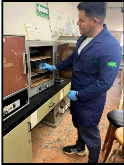
Figura 6. Ingreso de muestras sedimentarias al horno.
