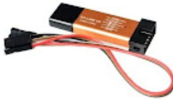
Figura 7: Programador ST-LINK V2.
