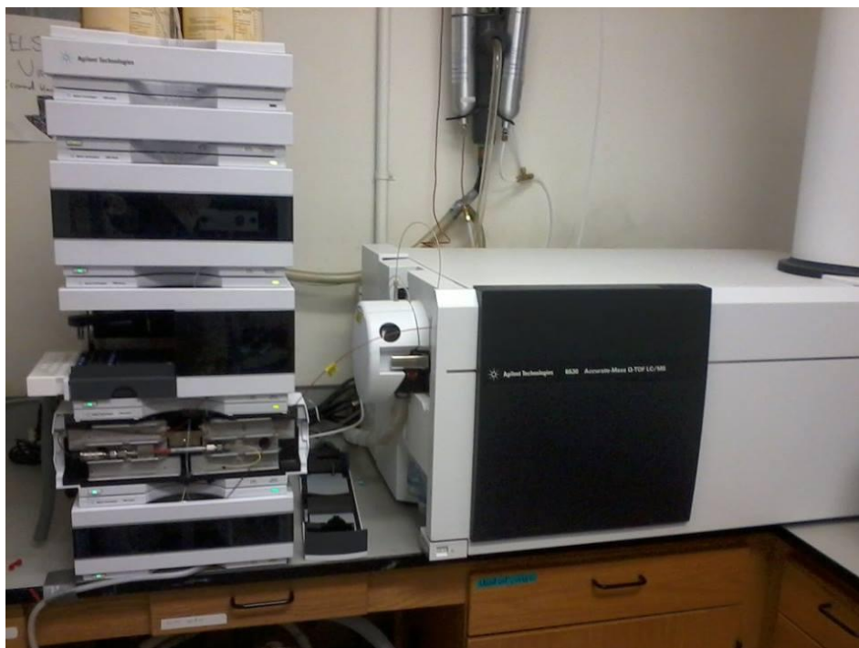
Figura 10. Espectrómetro Agilent 6530 Accurate-Mass Quadrupole Time-of-Flight (Q-TOF) LC/MS situado el Centro de Biología Marina y Biomedicina del Instituto de Oceanografía SCRIPPS.
