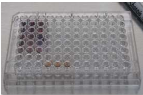
Figura 12.- Placa CORSAR conteniendo los cementos con el reactor MTS, listos para el análisis.
