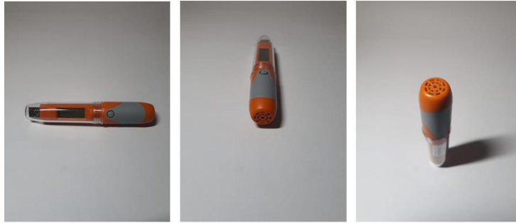
Figura 9. Vistas del registrador de datos Elitech ® RC-51H. Elaboración propia
