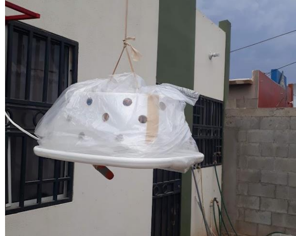
Figura 43. Protección de sensores exteriores ligeras lluvias. Elaboración propia
