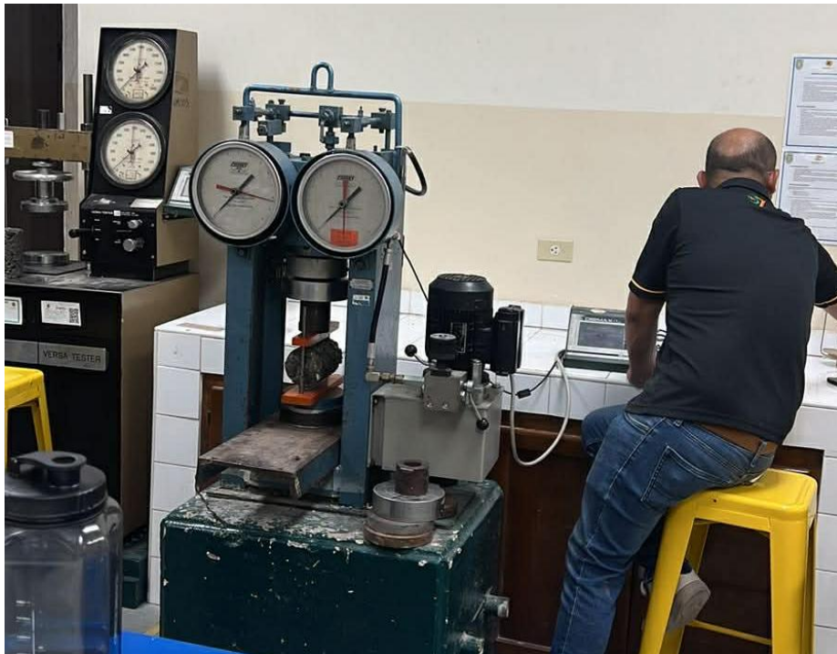
Figura 20. Aplicación de pruebas de resistencia en cilindros.
