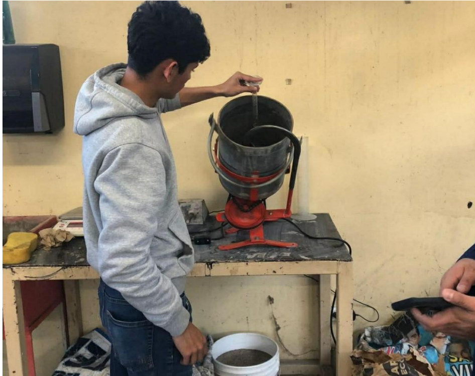
Figura 10. Elaboración de la mezcla de mortero.
