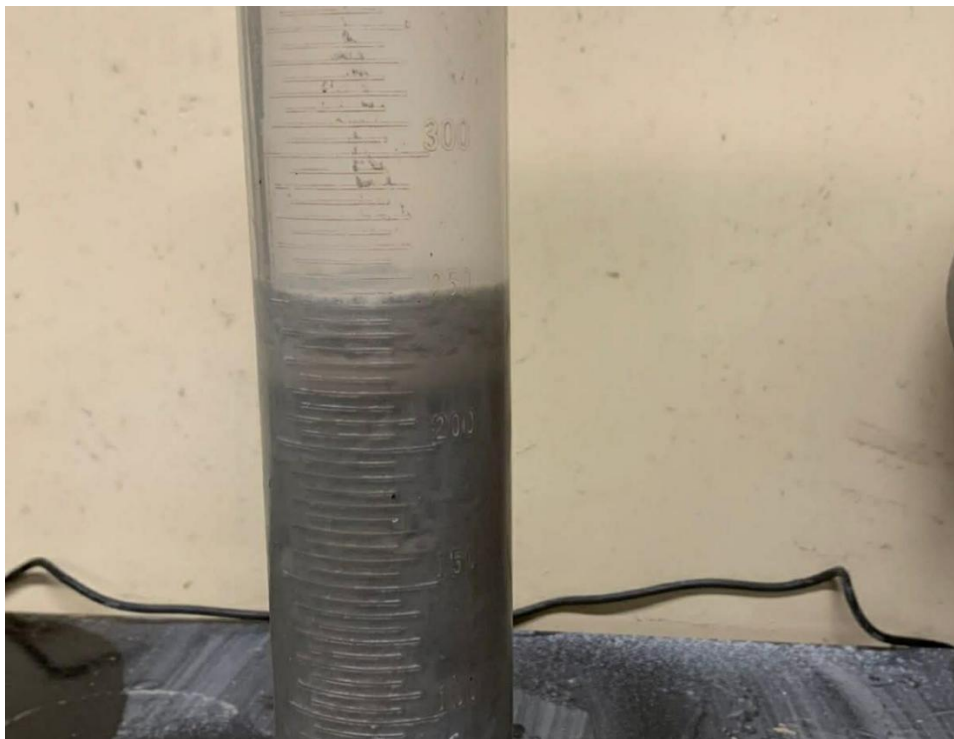
Figura 11. Resultados de pruebas de sangrado. (sedimentación)
