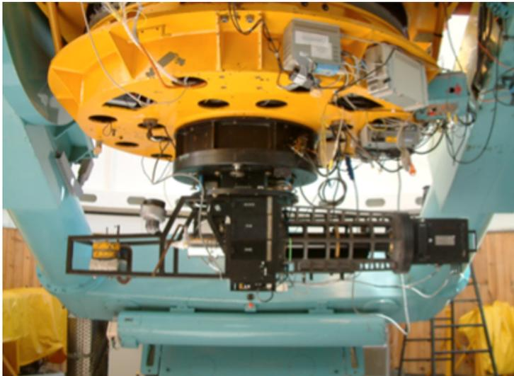
Figura 20: Espectrógrafo MEZCAL. Cortesía del Dr. Roberto Vázquez
