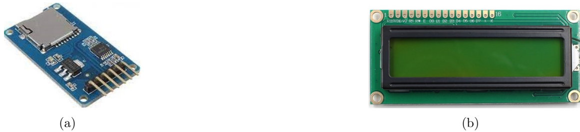
Figura 5.4: Componentes utilizados en el sistema diseñado: a)Módulo para lectura de tarjeta micro SD, b)LCD 16x2.
