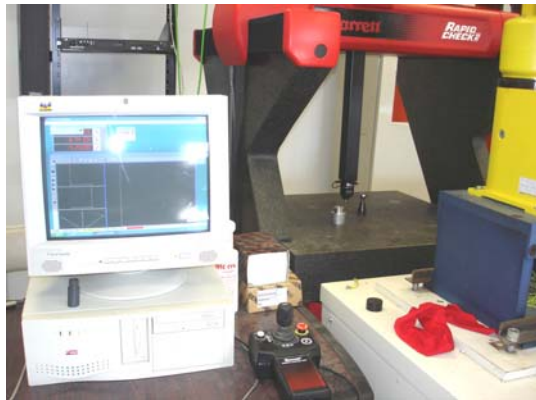
Figura. VI.1. CMM y medición de pieza manufacturada
