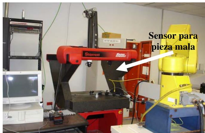
Figura VI.2 Sensores externos para determinar si es pieza buena o mala
