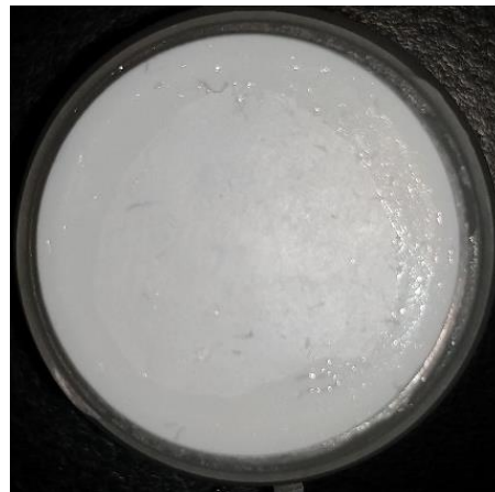
Figura 7. Membrana de 0.45 \mu\text{m} para filtrar el TPP. Se observan las partículas que se eliminaron del filtrado.
